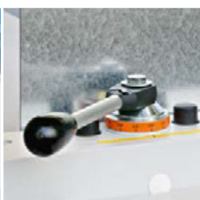
Werkzeugfrei justierbare Schnittspalteinstellung
