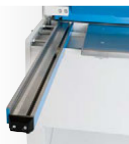
Verlängerbare Winkelanschläge und Auflagearme mit T-Nut (optional erhältlich)
