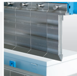
Segments hauts du tablier supérieur
