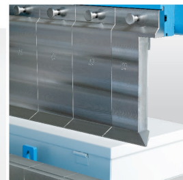
Segments hauts du tablier supérieur
