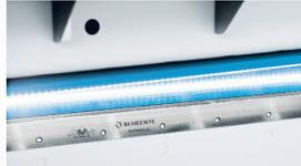
L'éclairage d'atelier apporte une lumière diffuse et la barre de coupe jette des ombres. Cela n'aide pas l'opérateur à bien déterminer la position de coupe.
