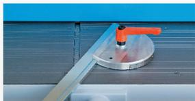
Le ferblantier obtient des coupes biaisées précises en utilisant une butée d'angle spéciale. La barre de butée et le disque gradué sont alors fixés de manière simple et sûre avec un levier de serrage.
