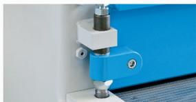
L'opérateur a ainsi les éléments à découper bien en main, sans avoir à fournir un effort manuel important et en appuyant seulement sur un bouton. Le serre-flan maintient la tôle dans la bonne position de manière sûre. Avec la pièce antiglisse en caoutchouc dur, la surface sensible des éléments à découper est également protégée contre les rayures.
