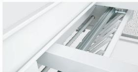
Comme extension à la butée de profondeur réglable manuellement pour les modèles HT, nous recommandons la table basculante qui dépose vers l'avant les éléments découpés dans le respect des matériaux. Il est ensuite possible de les retirer en tout confort ou de les transporter sur le chariot d'empilement de tôle.
