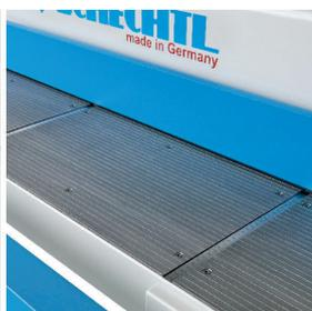
Plateau gradué et support de tôle extensible
