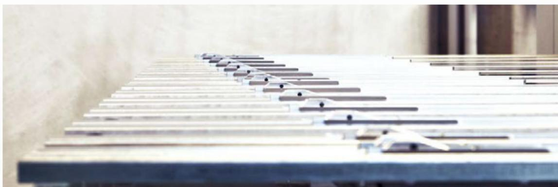
La butée arrière SCHECHTL pour le pliage conique simplifie la production de nombreux profils de tôle. Les profilés emboîtables et les solins peuvent désormais être produits de manière précise et efficace. Les étapes de traitement fastidieuses sur le chantier sont supprimées. La butée arrière est donc idéale pour les applications nécessitant des lignes de bord qui ne sont pas parallèles. Par exemple, pour les gouttières, les plaques d'égout et les couvertures.
