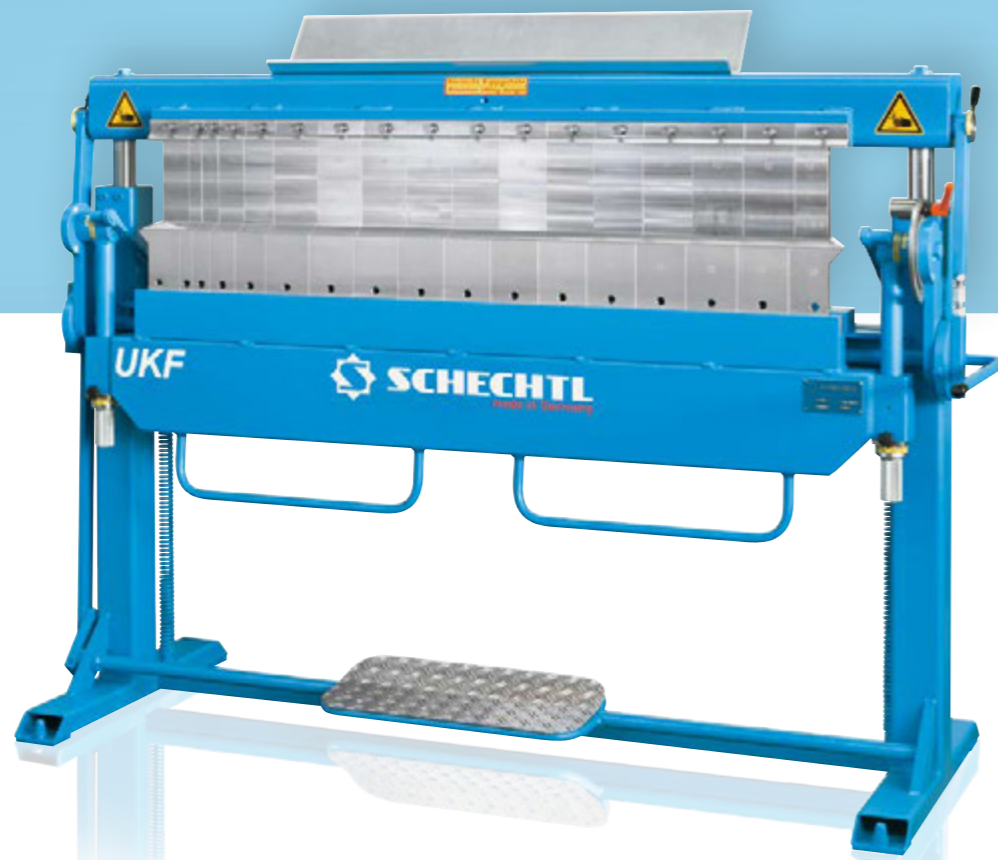
Séries spéciales en une opération de travail, table universelle mobile de butée UA 125 pour guider la tôle
