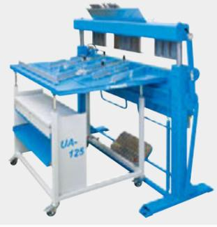
Guidage de la tôle au moyen de rails de guidage magnétiques, librement ajustables.
