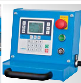
Programmierbare Schnittsteuerung und Datenbank für Schnittprofile und Schnittfolgen (Steuerungsvariante NC+NCH)
