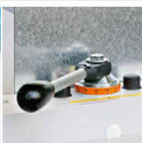
Werkzeugfrei justierbare Schnittspalteinstellung
