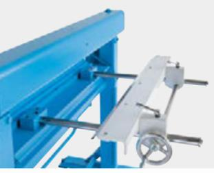
UKV manueller Tiefenanschlag mit Zahnstange und Handrad.
