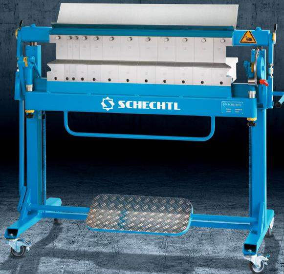
Mit der Schechtl UK bewältigt ihr Aufträge für Sonderformen, Kasten- und Schachtelformen sowie Anpassarbeiten. Sie biegt bis zu 1,50 mm Stahl und ist in den Arbeitslängen 1 m und 1,25 m erhältlich. Die umfangreiche Serienausstattung und viele Erweiterungsmöglichkeiten machen die UK zu einem echten Multitool.
