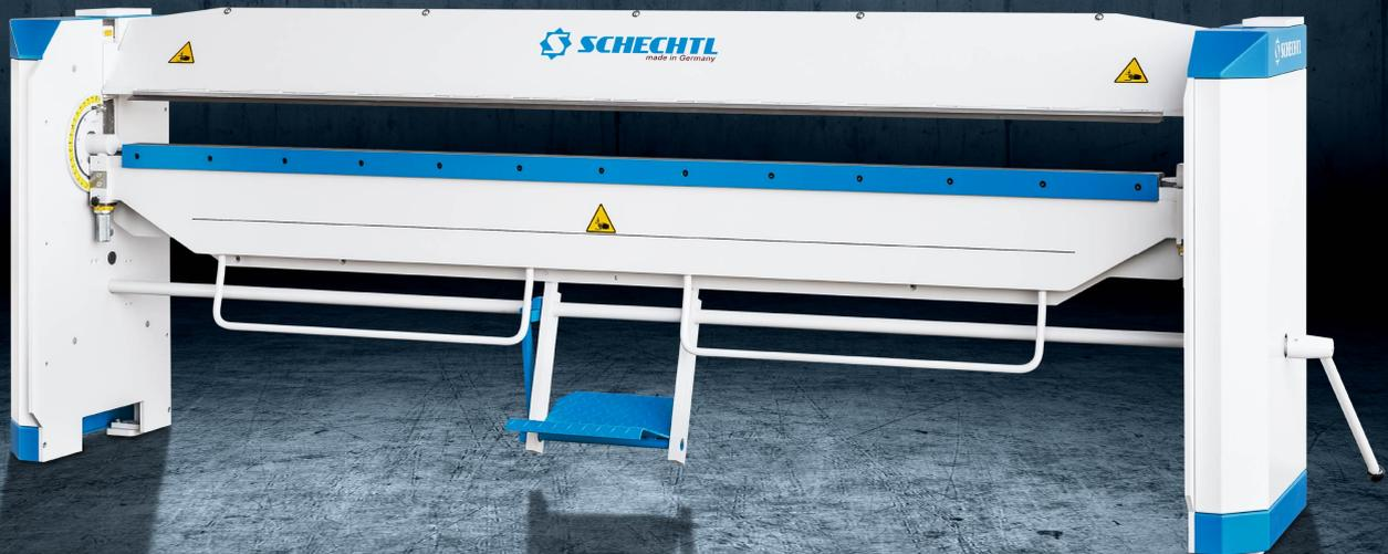
Du suchst eine manuelle Abkantbank die 3 Meter lange Bleche biegt? Dann ist die Schechtl HBM genau die Richtige! Die HBM hat eine Biegeleistung von 1,00 mm Stahl und ist so robust gebaut, dass sie praktisch unkaputtbar ist. Die Kombination aus Präzision, Kraft und umfangreichen Zubehöroptionen machen die HBM zum leistungsstarken Werkzeug für deine Werkstatt.
