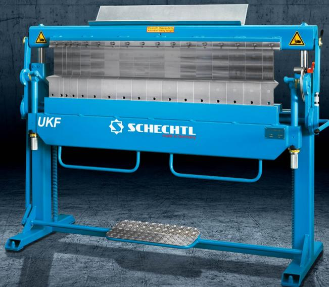
Con l'UKF di Schechtl è possibile gestire ordini di forme speciali, forme di scatole e cartoni e lavori di montaggio. L'UKF offre spazio per inserti di segmenti alti 160 mm o 180 mm sulla traversa superiore. I segmenti sulla traversa inferiore e di piegatura hanno un'altezza di 120 mm: il 100% di libertà in più rispetto all'UK o all'UKV. Questa libertà offre molti vantaggi nella produzione di forme chiuse più grandi.
