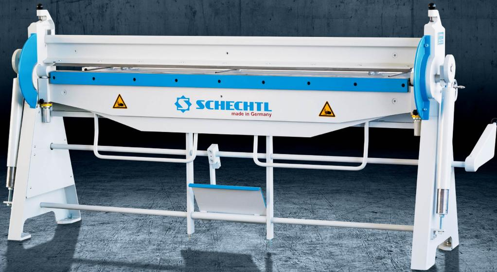
La Schechtl KSV è la versione rinforzata della KS ed è disponibile anche nella lunghezza di lavoro di 2540 mm. La traversa superiore è costituita da profilati laminati, la traversa inferiore e di piegatura da una struttura in acciaio. Le numerose opzioni di accessori e le versatili possibilità di regolazione fanno della KSV la macchina ideale per il settore della lattaeria.
