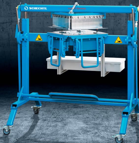
Con la SB di Schechtl è possibile produrre scandole in modo rapido e semplice. La SB piega due bordature o risvolti disposti ad angolo di 90 gradi l'una rispetto all'altra. Le traverse di bloccaggio sono dotate di segmenti intercambiabili, in modo da rendere estremamente semplice la produzione di scandole quadrate e rettangolari o di altri componenti. Inoltre, la SB 24 riduce a 8 le fasi di lavoro convenzionali. Ciò si traduce in un risparmio di tempo di circa il 70%.
