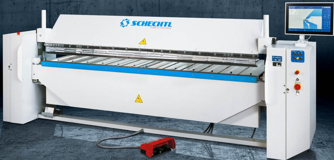
Con il suo potente azionamento del mandrino, la MAE di Schechtel è la più robusta tra le piegatrici orientabili a motore Schechtel. Il sistema a scatto di serie garantisce tempi di allestimento minimi e consente di installare facilmente utensili speciali in qualsiasi momento. Inoltre, la solida struttura saldata, priva di torsioni, garantisce la longevità della macchina anche in caso di uso continuo e intenso.
