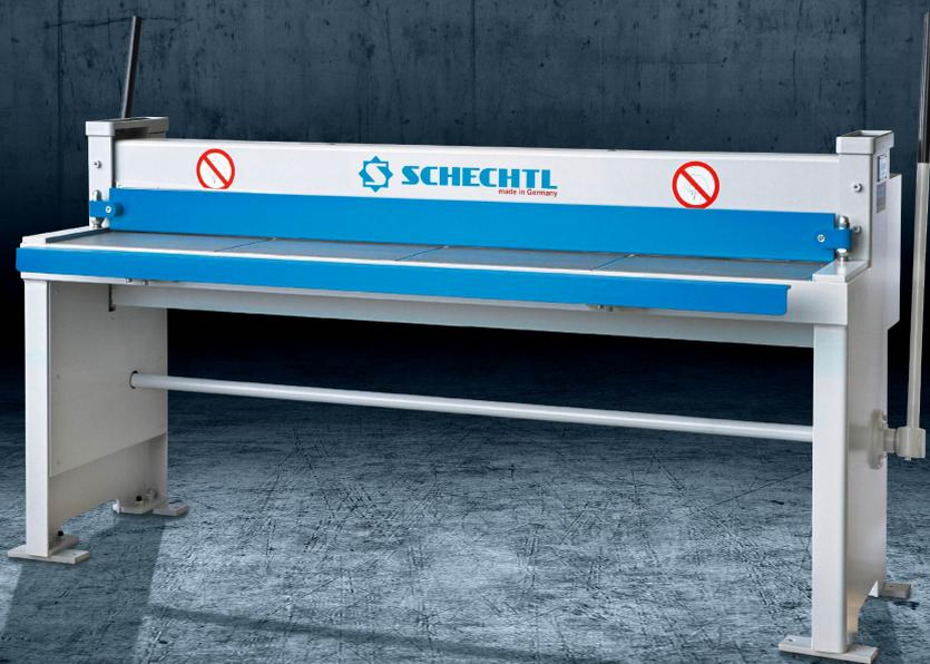
La qualità di taglio della cesoia a ghigliottina manuale HT definisce gli standard e raggiunge il livello delle cesoie a ghigliottina a motore. Può essere utilizzata ovunque non sia possibile o necessaria l'alimentazione elettrica. La gamma di profili parte dall'HT 100 con una lunghezza di lavoro di 1040 mm e arriva all'HT 310 con una lunghezza di lavoro di 3140 mm. Il design ergonomico a risparmio energetico e l'ampia gamma di accessori fanno dell'HT un vero e proprio tuttofare.
