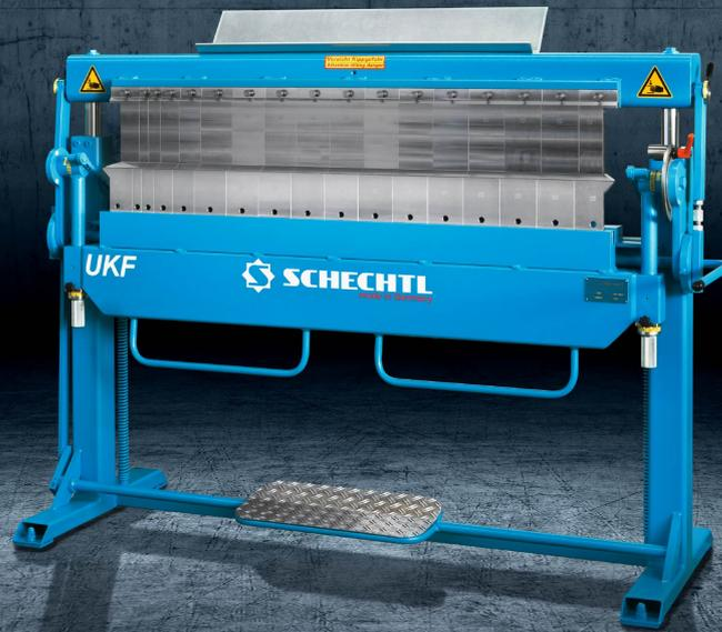
La Schechtl UKF permet de traiter des formes spéciales, des formes de cassettes et de boîtes, ainsi que de réaliser des travaux d'ajustage. L'UKF offre au niveau du tablier supérieur de l'espace pour des inserts en forme de segment de 160 mm ou 180 mm de haut. Les segments des tabliers inférieur et plieur sont de 120 mm de haut, cela représente 100 % de liberté en plus par rapport aux modèles UK et UVK. Cette liberté offre de nombreux avantages lors de la fabrication de grandes formes fermées.
