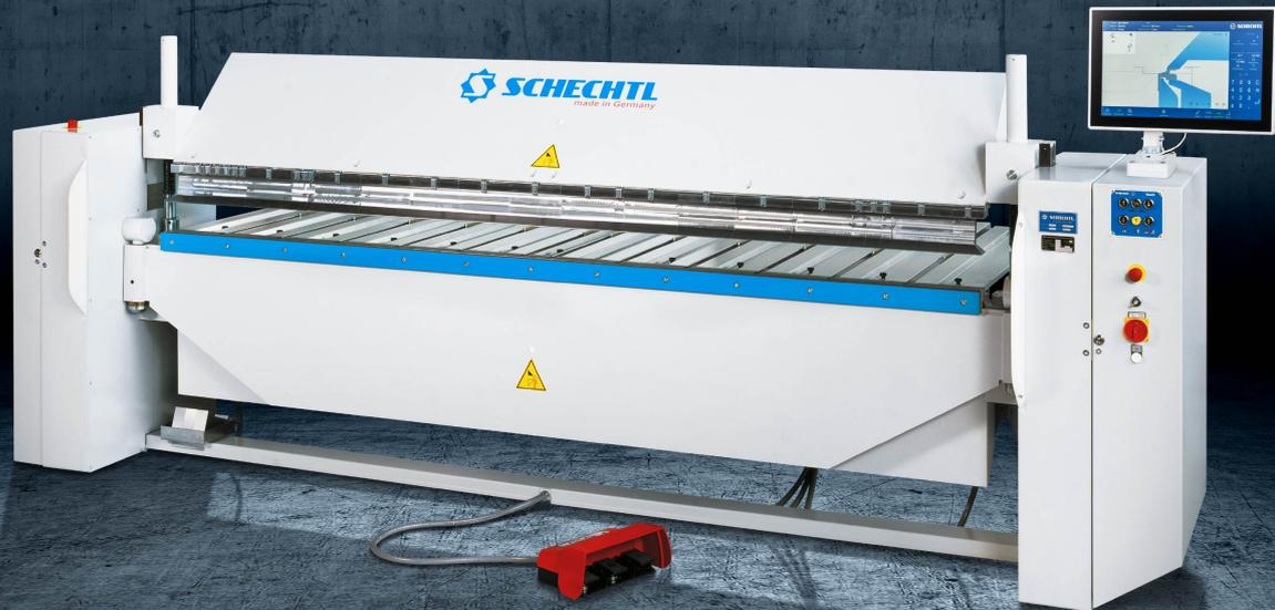
La Schechtel MAE, avec son entraînement à broche puissant, est la plus puissante des presses plieuses motorisées de Schechtel. Le système d'encliquetage en série garantit des temps de préparation minimaux et permet à tout moment de rajouter facilement des outils spéciaux. De plus, la construction soudée massive, exempte de torsion garantit la durabilité des machines, même en cas de sollicitation forte continue.
