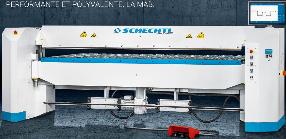
Schechtl MAB est la version renforcée de MAX. Elle est construite de manière encore plus massive et présente donc une puissance de pliage plus élevée. Grâce à différentes variantes de commande et possibilités de butée arrière, ainsi qu'à un large choix de rails, le modèle MAB peut être parfaitement adapté aux besoins.
