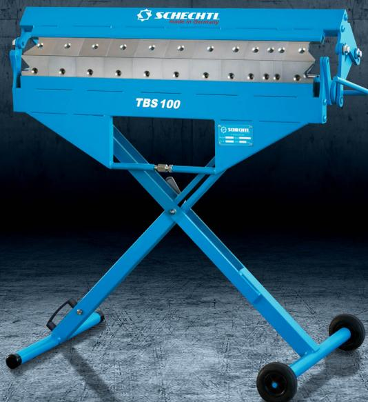
La TBS est la plus petite des plieuses manuelles à segments de la gamme Schechtl, mais elle est digne des grandes en ce qui concerne sa flexibilité sur le chantier. Grâce à ses petites dimensions, tu peux déplacer la TBS sans effort sur le chantier – entre les étages, sur l'échafaudage et dans les pièces étroites. De plus, la TBS peut être montée sur un établi ou dans un véhicule de chantier.
