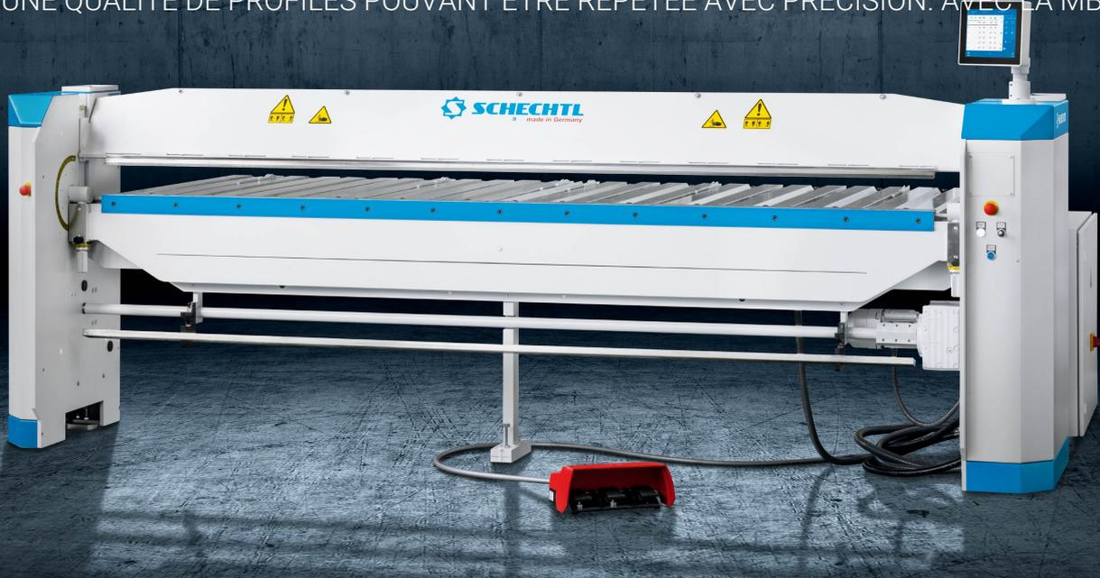
Là où les presse plieuses manuelles atteignent leurs limites, la MBM vous offre un plus énorme en matière de fonctionnalité et de rentabilité. La MBM est idéale pour l'usinage de tôle mince jusqu'à 1,00 mm de tôle d'acier, la fabrication unitaire répétitive et la fabrication en petites séries. La commande ECT de série permet de répéter facilement les profilés, même complexes.
