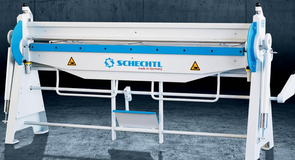
La Schechtl KSV est la version renforcée de la KS, elle est également disponible dans la longueur de travail 2 540 mm. Le tablier supérieur se compose de profilés laminés, le tablier inférieur et le tablier plieur sont obtenus à partir d'une seule construction en acier. Ses nombreux accessoires et ses diverses possibilités de réglage font de la KSV la machine ultime dans la ferblanterie.
