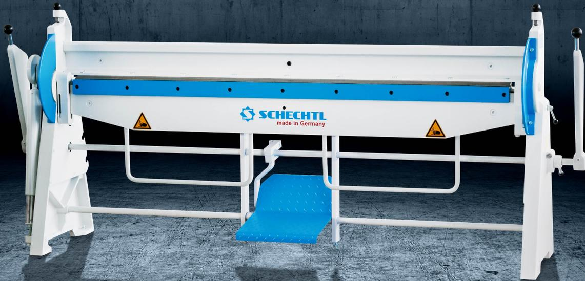
La Schechtl KS est la plus appréciée parmi les petites presses plieuses manuelle dans la ferblanterie. Le tablier supérieur se compose de profilés laminés, le tablier inférieur et le tablier plieur sont obtenus à partir d'une seule construction en acier. Ses diverses possibilités de réglage et ses nombreux accessoires ont fait de la KS la presse plieuse à entraînement excentrique la plus vendue au monde, avec 28 000 exemplaires.
