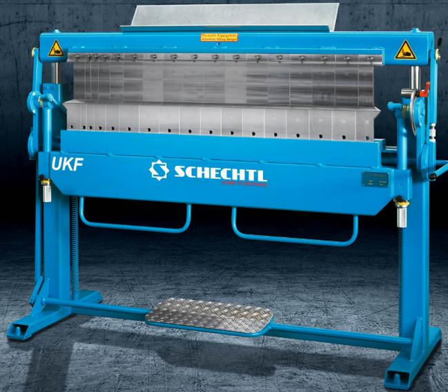
Mit der Schechtl UKF bewältigt ihr Aufträge für Sonderformen, Kasten- und Schachtförmigen sowie Anpassarbeiten. Die UKF bietet an der Oberwange Raum für 160 mm oder 180 mm hohe Segment-Einsätze. Die Segmente an der Unter- und Biegewange sind 120 mm hoch - das sind im Vergleich zur UK oder UKV 100 % mehr Freiheit. Diese Freiheit bietet bei der Herstellung von größeren geschlossenen Formen viele Vorteile.
